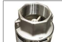
Clapet anti-retour testé x1.000.000 de coups de bélier à 37 bars
